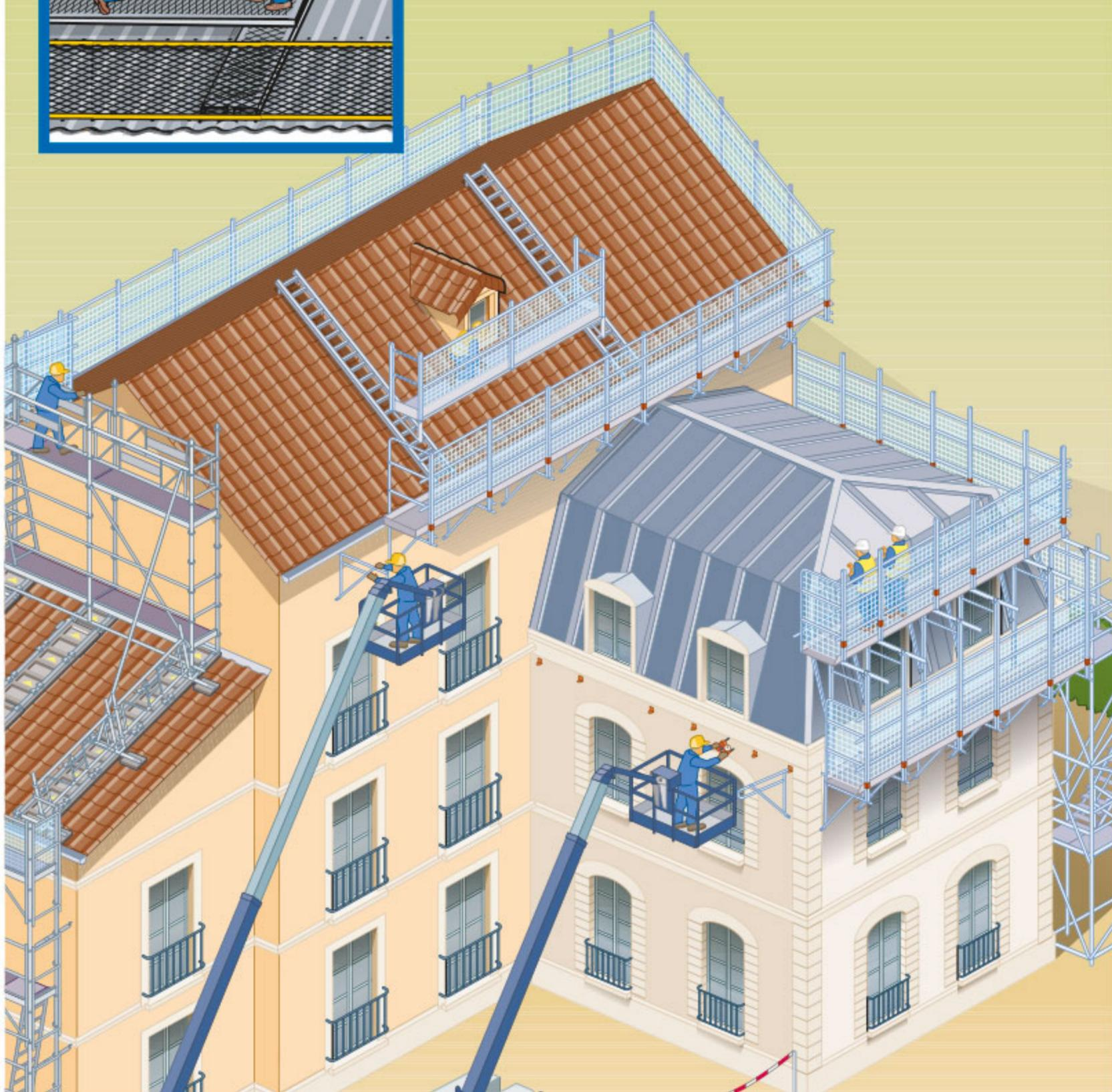
**Lors de travaux sur toitures, dont certaines sont en matériaux fragiles, la zone de travail doit être protégée par des protections périphériques et en sous-face.**
